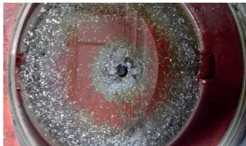
Prokazatelné poškození ložisek – vydrolený materiál z válečků ložisek
