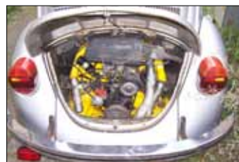
Motor Brouka – čtyřválcový plochý boxer, vzduchem chlazený. Tento motor se používal i v jiných zařízeních než v autech, např. v hasičských čerpadlech, kompresorech, kombajnech, letadlech, lodích, hokeyových frézách apod.
