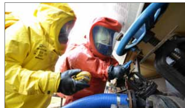
Otvírání kapalně fáze na cisterně za použití ochranných oděvů a detektoru.
