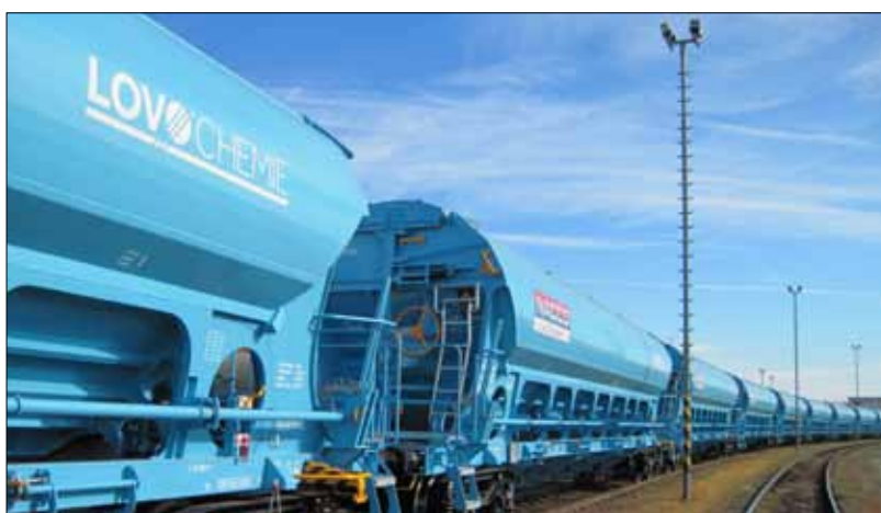
Vlak složený z 82 m³ výsypných vozů, pronajatých od společnosti NACCO. Foto: Lukáš Verner
