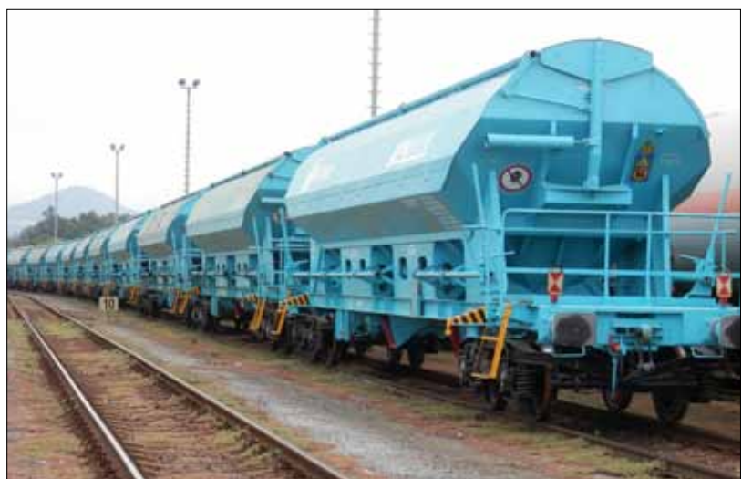
Vlak složený z 65 m³ výsypných vozů, pronajatých od společnosti ERMEWA. Vozy byly kompletně opraveny, mají nový vnitřní a vnější nátěr. Foto: Jiří Trojan
