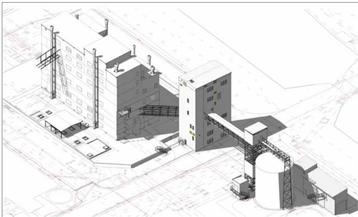
Počítačový model vzhledu budoucí výroby extrudovaných řepkových šrotů. Budova vlevo je stávající budova extrakce, plánovaná výrobní budova extrudovaných řepkových šrotů včetně skladu je vyobrazena na obrázku uprostřed a vpravo dole. Zdroj: archiv PREOL
