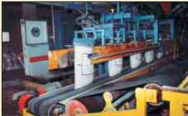
Pytlovací linka ledku amonného s vápencem – LAV
