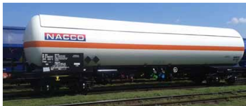
Nová 104 m³ cisterna na amoniak.
