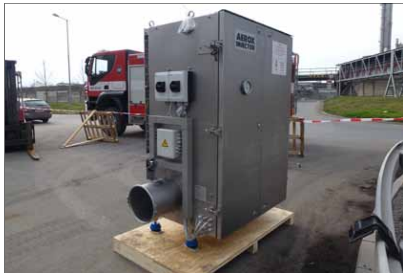
Jádro celého zařízení, jednotka AEROX, před vyzvednutím na místo montáže.
