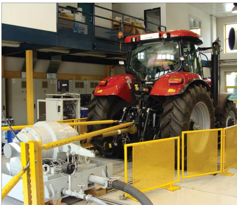
Součástí provozních zkoušek bylo i měření vlivu použití paliva B100 na výkon motoru a spotřebu paliva.
