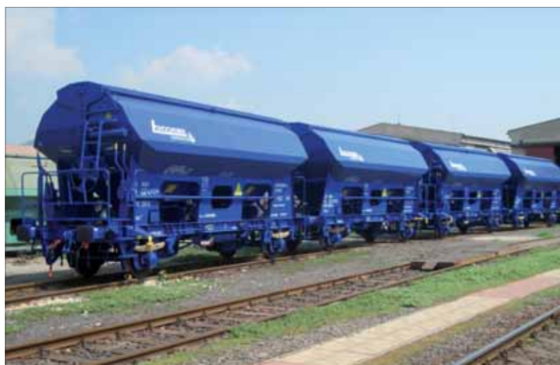
Vagony k přepravě volně loženého sypkého hnojiva.
