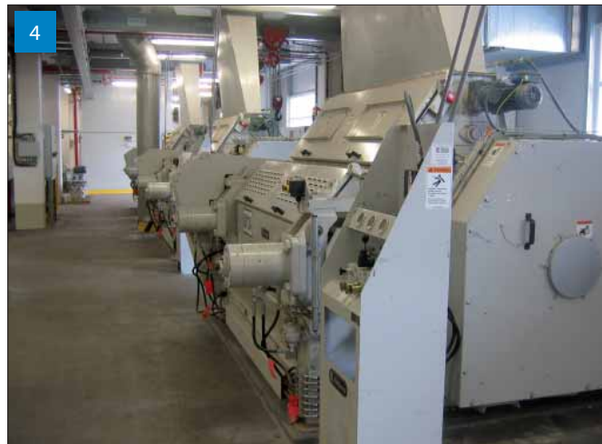
Vločkovací stolice - Další stupeň přípravy semene pro co nejefektivnější lisování. Zde se semeno „rozmázne“ do tvaru vločky, aby bylo lisování co nejefektivnější.
