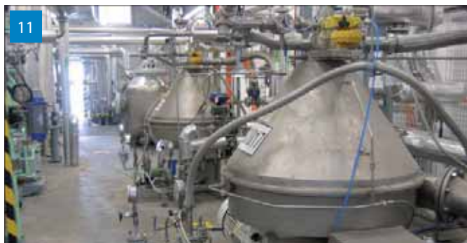
Úprava oleje - Samostatná jednotka, jejímž úkolem je snížení obsahu volných mastných kyselin a obsahu fosfolipidů. Snížení obsahu fosfatidů se provádí tzv. odsazením, kdy se na olej působí kyselinou fosforečnou a následně louhem sodným. Vysrážené fosfatidy se odstraní odstředěním. Snížení kyselosti oleje, tj. odstranění volných mastných kyselin, se provádí neutralizací roztokem louhu sodného, promytím vodou za použití separačních odstředivek na snímku.
