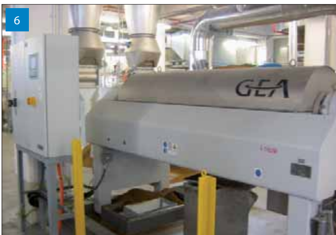
Dekantér - Zařízení, na kterém se čerstvě vylisovaný olej zbavuje pevných zbytků semen.
