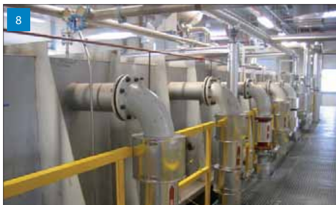
Extraktor, na snímku jeho vrchní část, kde se z vylisků vyextrahuje zbytek oleje, až na obsah zbytkového oleje 1 %.
