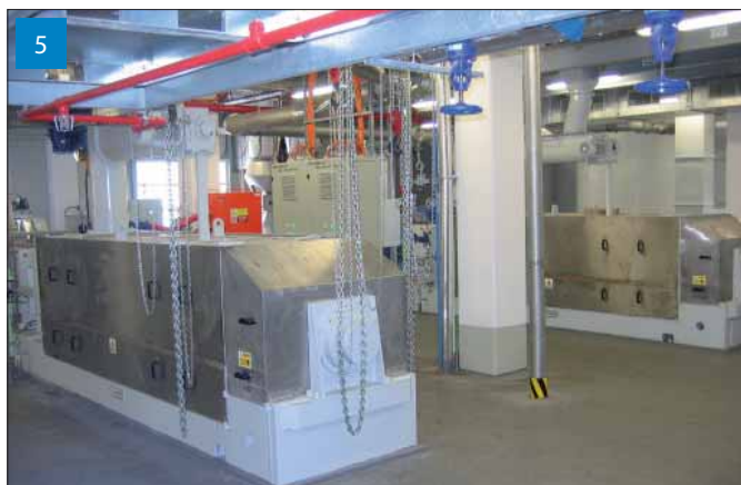
Lisy - V PREOL se využívají dva, každý o kapacitě 650 tun/den. Úkolem je získat ze semene zhruba polovinu obsahu oleje. Výstupem z lisů jsou řepkový olej a vylisky, tedy rozmačkané semeno obsahující stále asi 20 % oleje.
