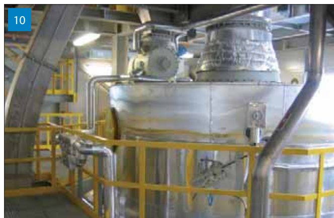
TOASTR - Zařízení, ve kterém se řepkové šrotky zbavují hexanu, chladí a suší.
