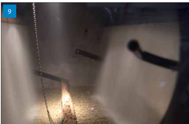
Pohled dovnitř extraktoru - Vylisky se sprchují organickým rozpouštědlem, v našem případě hexanem. Hexan se poté z oleje odstraní destilací.
