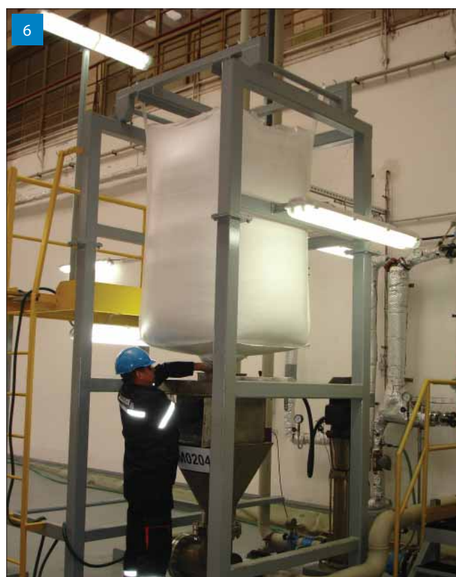
Obsluha při dávkování močoviny do ejektoru. Vznikající roztok cirkuluje mezi příslušným zásobníkem a ejektorem do doby, dokud nedojde k rozpouštění potřebného množství big bagů na předem určený objem vody.
