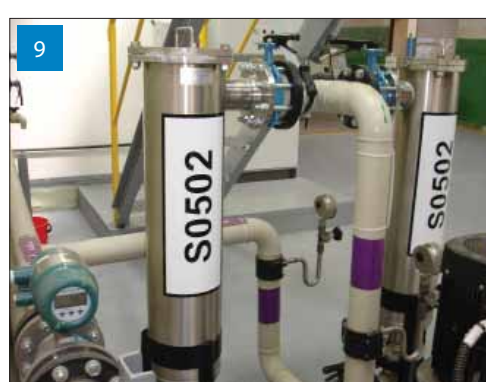
Tkaninový filtr sloužící ke koncové filtraci produktu.
