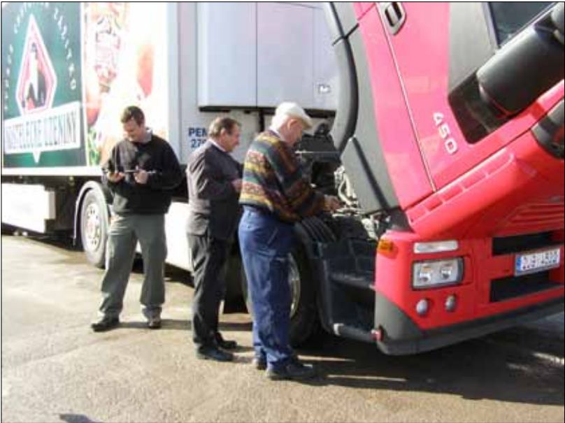
Odebírání vzorků oleje při testování bionafty v Kosteckých uzeninách, a.s. Foto: Karel Hendrych
