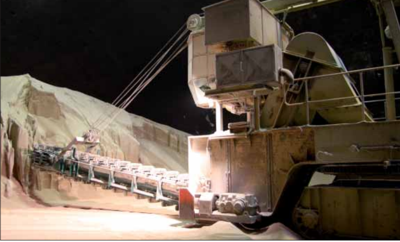
Výhrnovací stroj ve skladu LAV. Foto: Eva Živná
