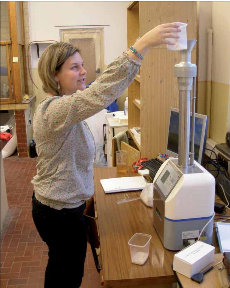
Příprava na samotné měření prachu – naplnění náspyky hnojivem. Foto: Eva Živná
