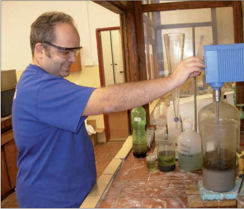
Laboratorní zkoušky rozkladu marockého fosfátu. Foto: Eva Živná
