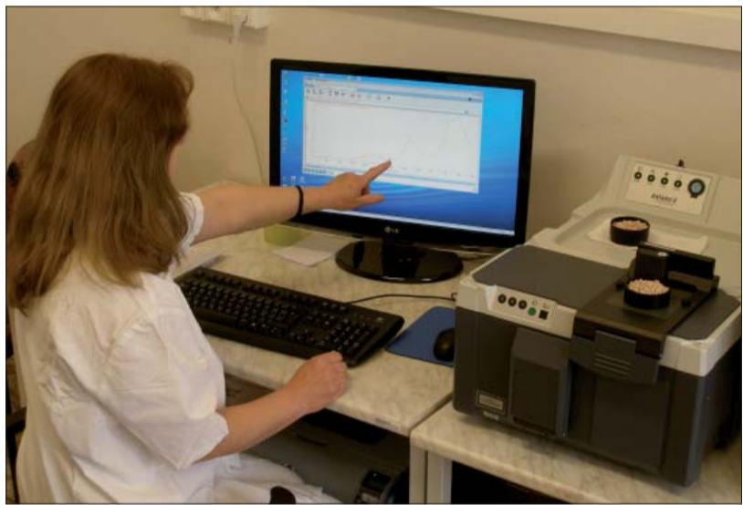
RNDr. Müllerová připravuje vzorek hnojiva LAD pro analýzu na FT-NIR.
