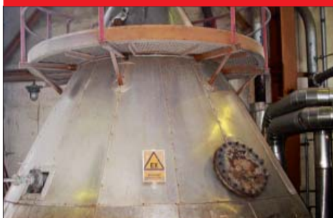
5. reaktor pro oxidaci vzduchočpavkové směsi
