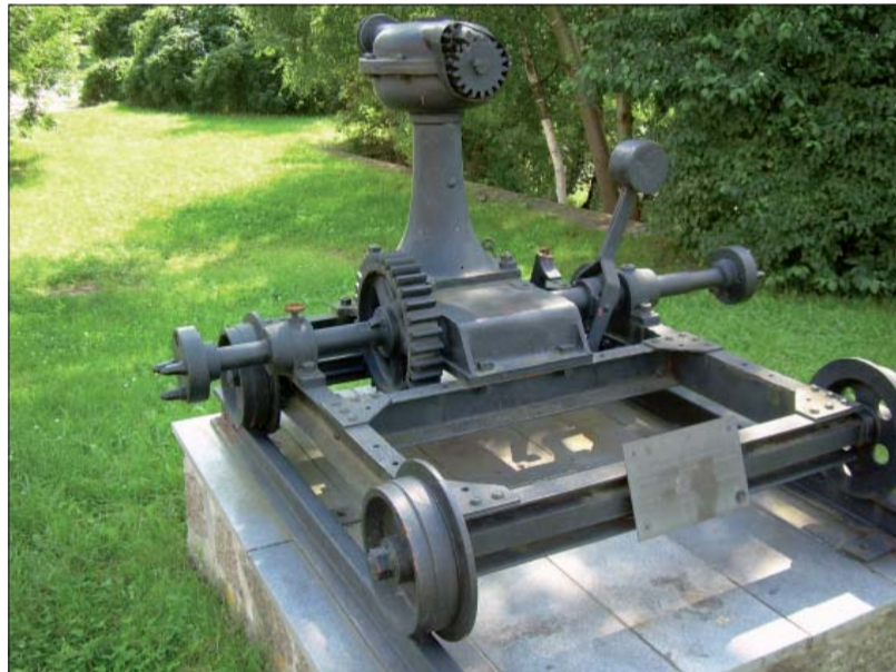
Mechanismus poklopotvého jezu.
