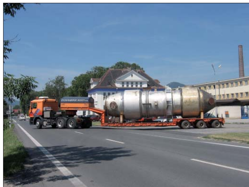
Zarážka výroby KD6 je limitována délkou opravy výměníku E3310 - ten byl demontován a odvezen k opravě do ZVU Potez Hradec Králové v neděli 22. 6. 2008.
