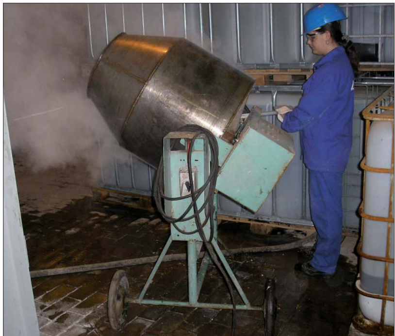
Bc. Monika Bencsová z oddělení výzkumu a rozvoje při granulaci síranu amonného s inhibitorem nitrifikace. Foto: Petr Šlemenda
