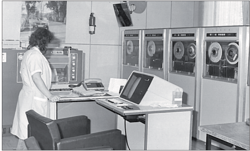
Pohled do sálu s počítačem TESLA 270. Vpravo magnetopáskové paměti, vlevo rychlotiskárna, uprostřed ovládací terminál. Zdroj: archiv OAIS
