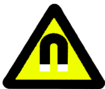
Nebezpečí - silné magnetické pole
