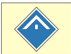
Koleje bez trakčního vedení v přímém směru
