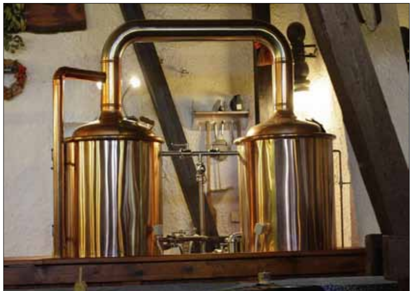
Vlevo je rmutovací pánev s bočním odtahem páry, kde proces vaření začíná. Po scezování zde probíhá chmelovar. Vpravo je scezovací kád, kde se přes scezovací dno odfiltruje mláto. V pozadí je polička s pivovarským náčiním.
